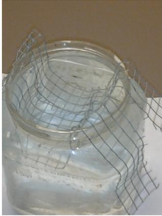
Remplir une bouteille d'eau et y déposer une motte de sol. Prendre une photo à ce moment. Prendre une autre photo 15 minutes plus tard.
