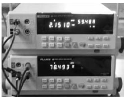
FIGURE 1 MULTIMÈTRES (FLUKE) POUR PRISES DE DONNÉES ÉLECTRIQUES
