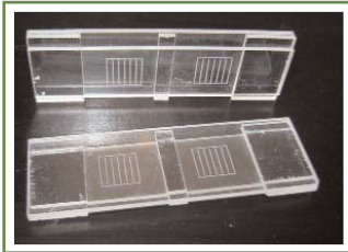
Figure 2.6 : La chambre McMaster: l'aire de lecture est constituée d'un quadrillage gravé dans le plastique
