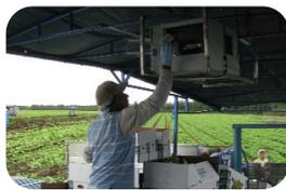
Pour les producteurs de laitue en champ, nous avons procédé à l'installation d'une imprimante à transfert thermique sur une récolteuse. Un ordinateur portable est alors utilisé afin d'envoyer les données pour générer les étiquettes. Cette option restreint par contre l'usage de l'imprimante aux produits récoltés avec cette récolteuse.
