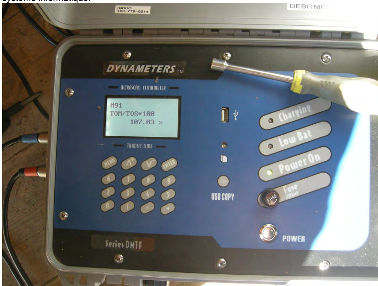
Figure 3: Débitmètre à ultrasons
