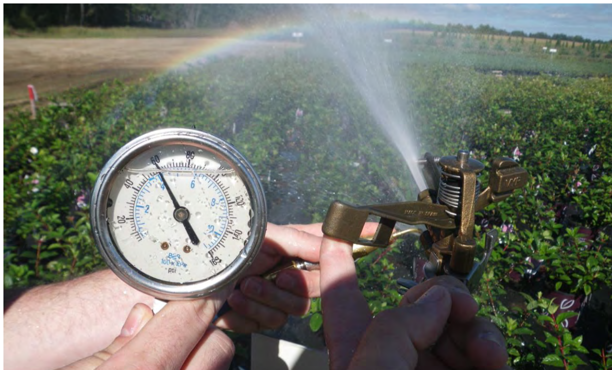
Figure 2: Lecture de la pression avec un tube de Pitot placé face à la buse de l'asperseur
