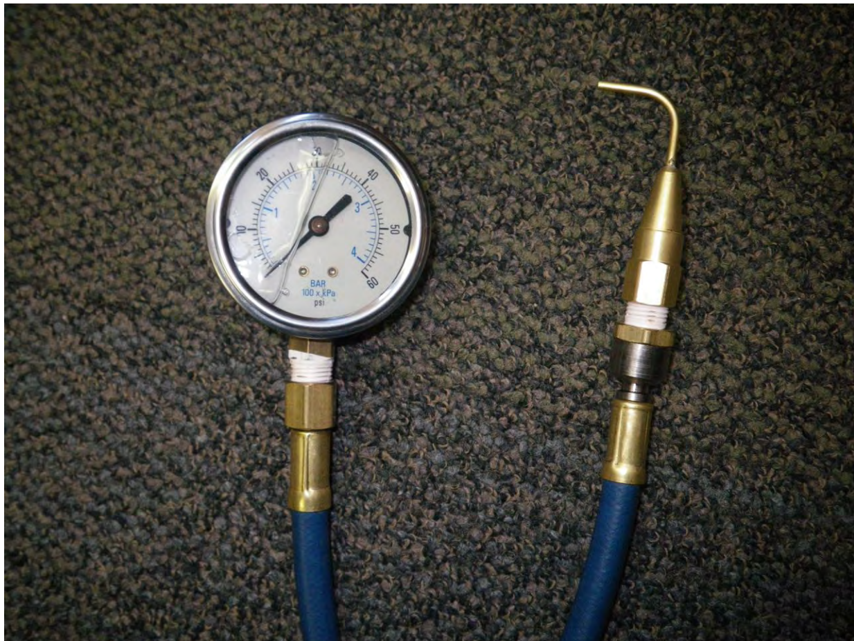
Figure 1: Manomètre avec tube de Pitot.
