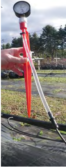
Figure 12: Manomètre adapté pour les systèmes d'irrigation goutte-à-goutte.
