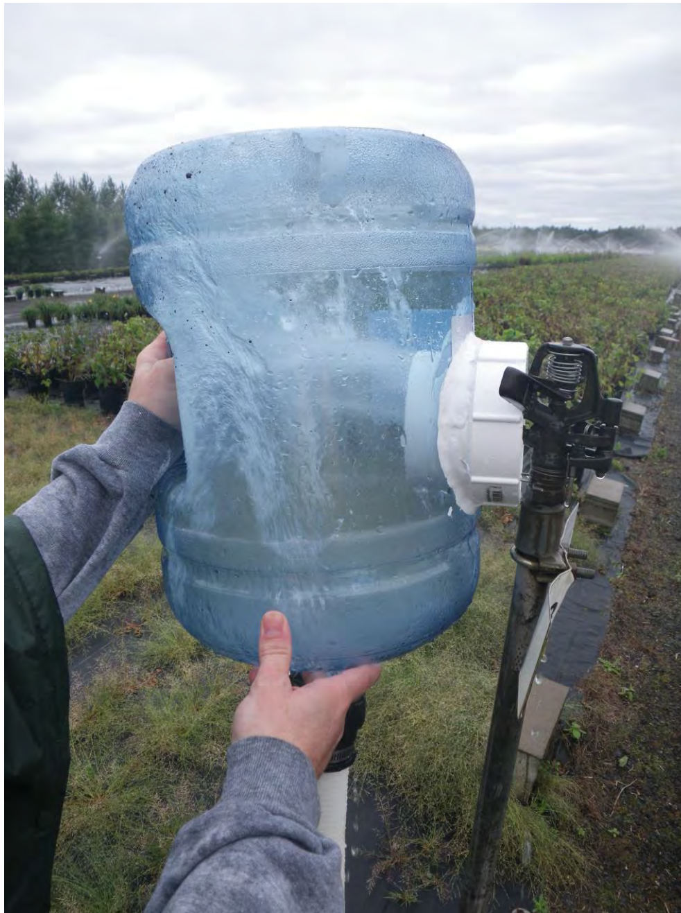
Figure 4: Mesure directe de l'asperseur avec un contenant de collecte
