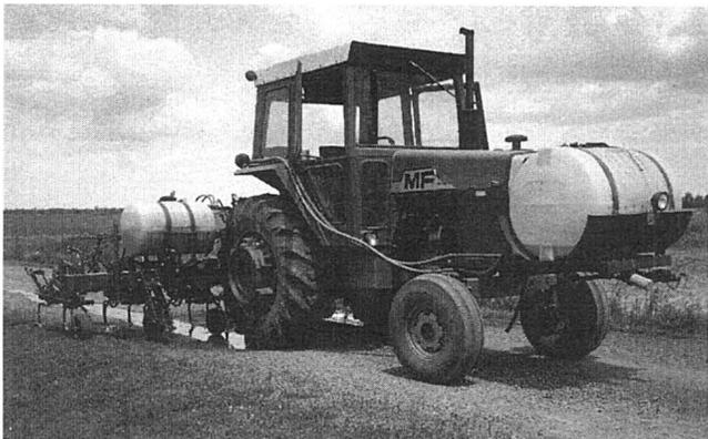
**Figure 1 : Le réservoir rond a l'avantage de se vider complètement**
