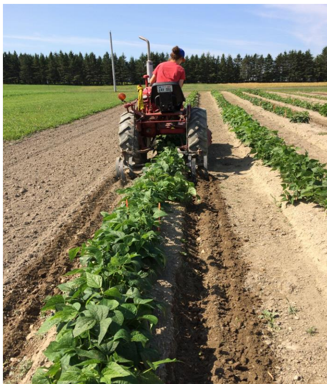
Photo 2.0 Sarclage mécanique des entre rangs de haricots nains avec un petit tracteur Farmall 140 doté d'une barre d'outils avec herse à ressort
