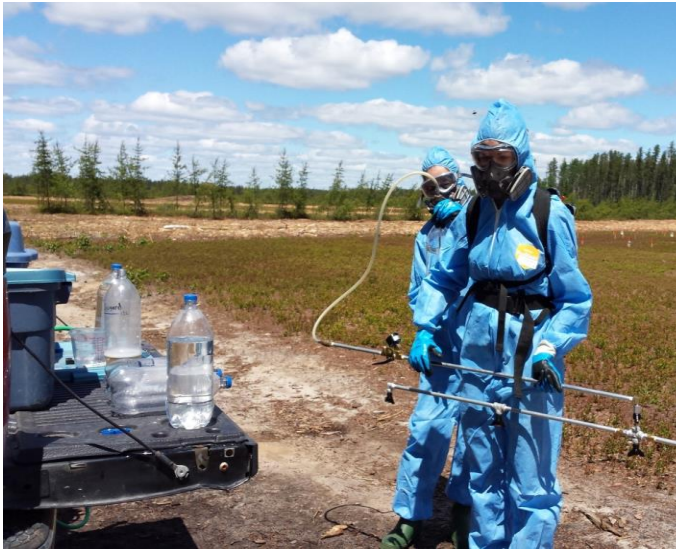
Figure 1 : Pulvérisateur et équipement de sécurité
