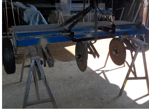
2. Installation des 3 disques tranchants
