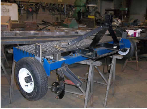
1. Montage de la structure du coupe-racine
