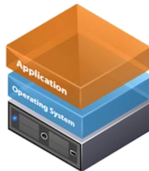
Serveur physique 1 serveur = 1 système d'exploitation
