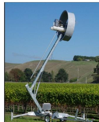
Machine à vent portable
