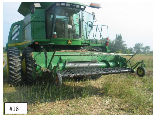
1 er septembre 2010 Moissonneuse-batteuse munie d'une table à andain
