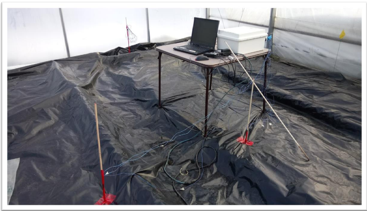
Figure 4. Acquisiteur de données raccordant 8 thermocouples placés verticalement sur 3 tiges : la tige 1: 5, 25 et 45 cm (à 4 m du 'H', près du diffuseur), la tige 2: 5, 25, 45 et 60 cm (À 4 m du 'H' entre les 2 diffuseurs) et la tige 3: 45 cm (à 7,5 du diffuseur)
