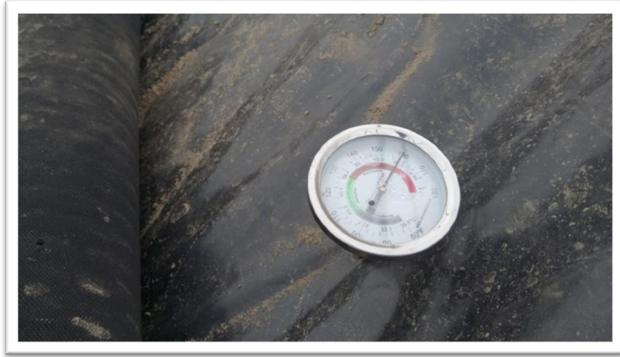
Figure 5. Usage d'un thermomètre de sol à tige rigide de 45 cm de longueur. Lorsque la température en arrière du diffuseur a atteint le seuil de 70°C, il est alors temps de déplacer le tout vers l'avant. Le taux d'avancement correspondait entre 1 et 2 m/heure.
