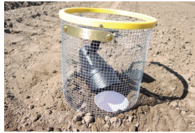
Piège-fosse lumineuse NELT MC
