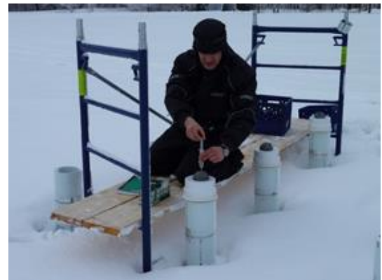
Martin Chantigny, Ph. D., mesurant les émissions de gaz au sol grâce à une technologie novatrice développée au CRD de Québec
