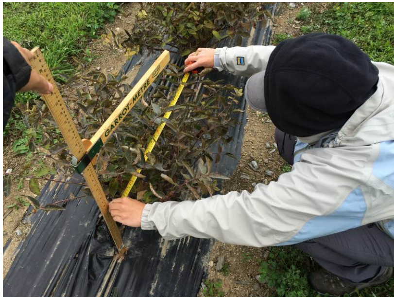
Figure 5. Photo montrant les instruments ainsi que la méthode utilisée pour réaliser la prise de mesures de croissance au cours du projet
