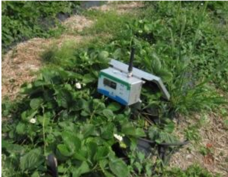
Figure 16. Tensiomètre installé dans une section de champ de fraises à jours neutres aux prises avec des mauvaises herbes.
