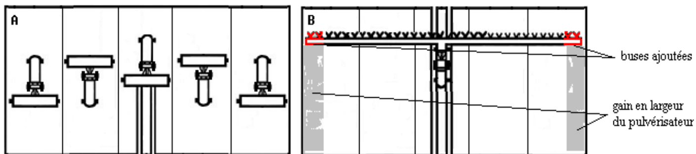
Figure 2. Illustration d'un ratio semoir/pulvérisateur de 1: 5 obtenu par l'extension de la rampe de pulvérisation et l'ajout de buses. Le rapport initial entre les deux équipements était de 1: 4.
