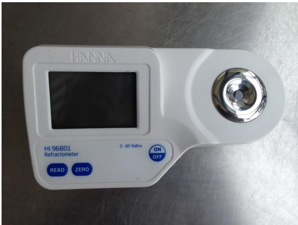
Figure 4. Réfractomètre Hanna Instruments-Hi 96801 utilisé pour déterminer l'indice Brix.
