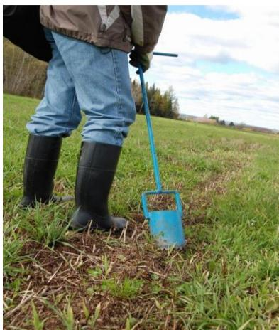
Figure 4 : Sonde d'échantillonnage
