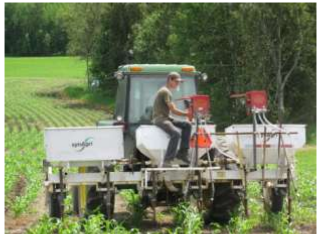
Semoirs Gandy avec tubes de descente et cuillères, sur l'incorporeur d'engrais granulaire de post-levée utilisé à la Ferme M. Grenier et fils inc.
