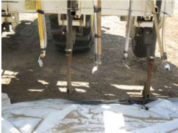
Semoirs Gandy avec tubes de descente et cuillères, sur l'incorporeur d'engrais granulaire de post-levée utilisé à la Ferme M. Grenier et fils inc.
