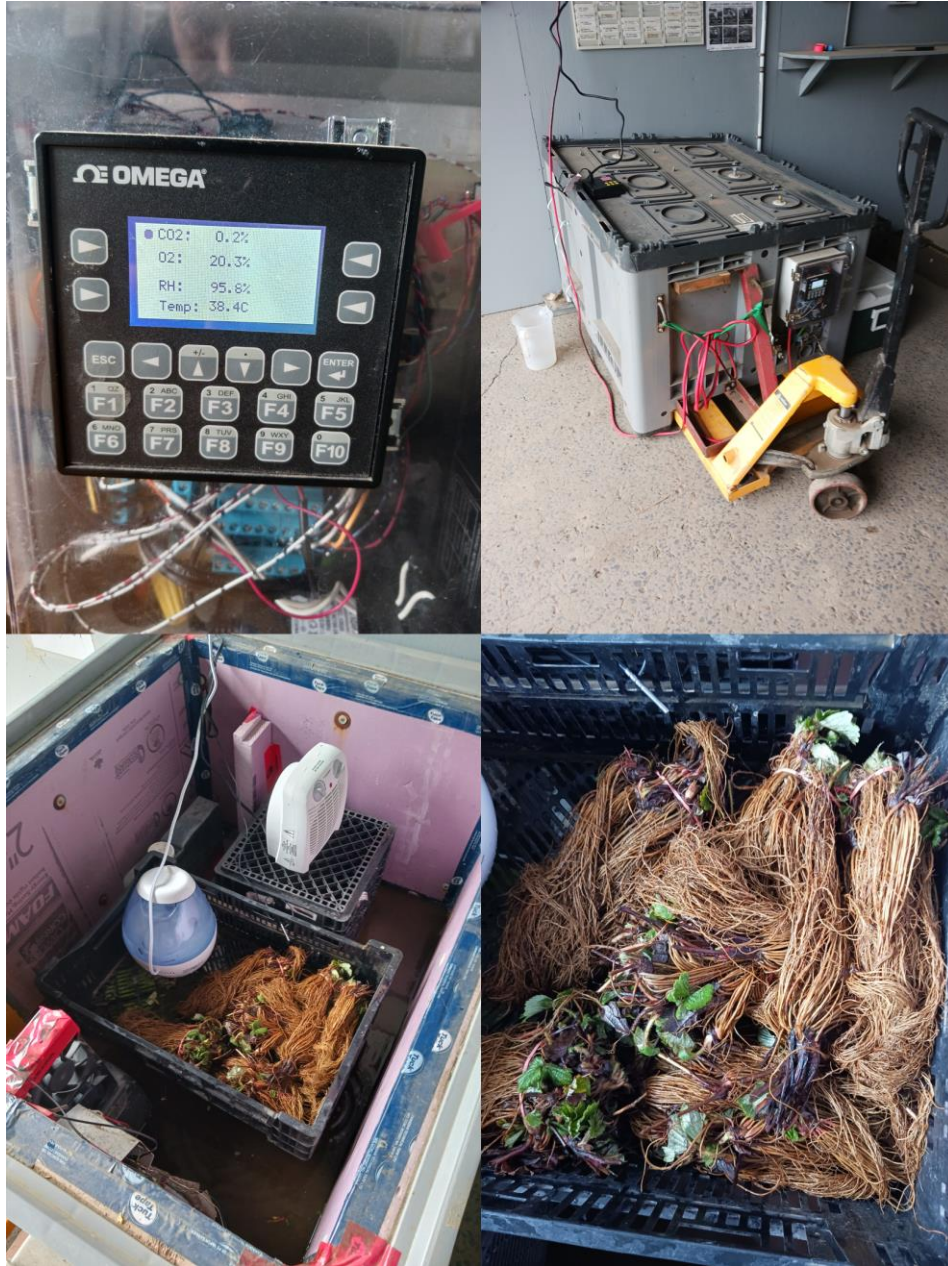
Figure S1. Caisse-palette en plastique hermétique (610 L) développée à l'Université Laval afin de lutter contre le tarsonème ( Phytonemus pallidus ) du fraisier.
