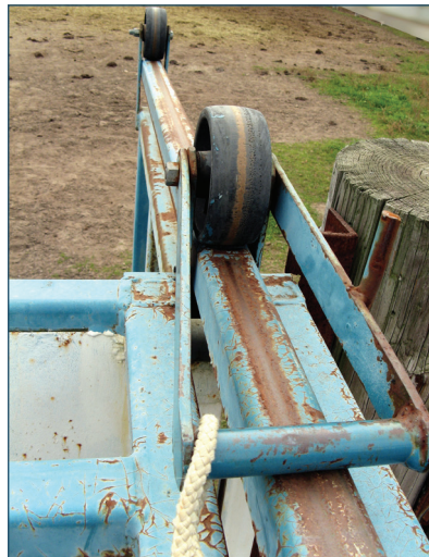
Figure 13. Roues de caoutchouc sur le rail
