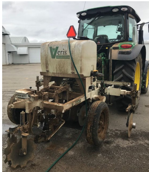
Figure 4 Équipements utilisés pour acquérir les données de conductivité hydroélectrique du sol – VERIS.
