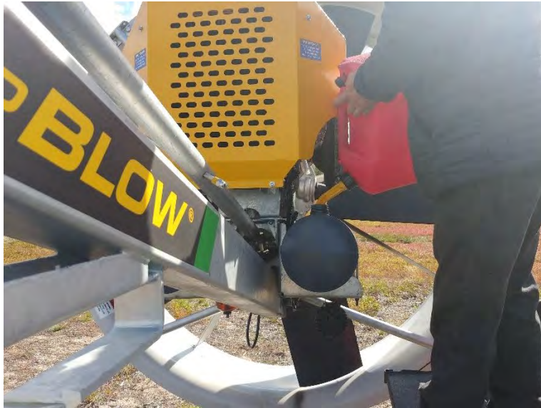
Figure 147. Remplissage du réservoir de diesel de la machine à vent en position abaissée.
