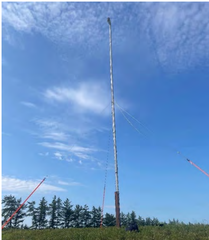
Figure 3. Tour utilisée pour le suivi de la stratification thermique de l'air au site « machine à vent ».
