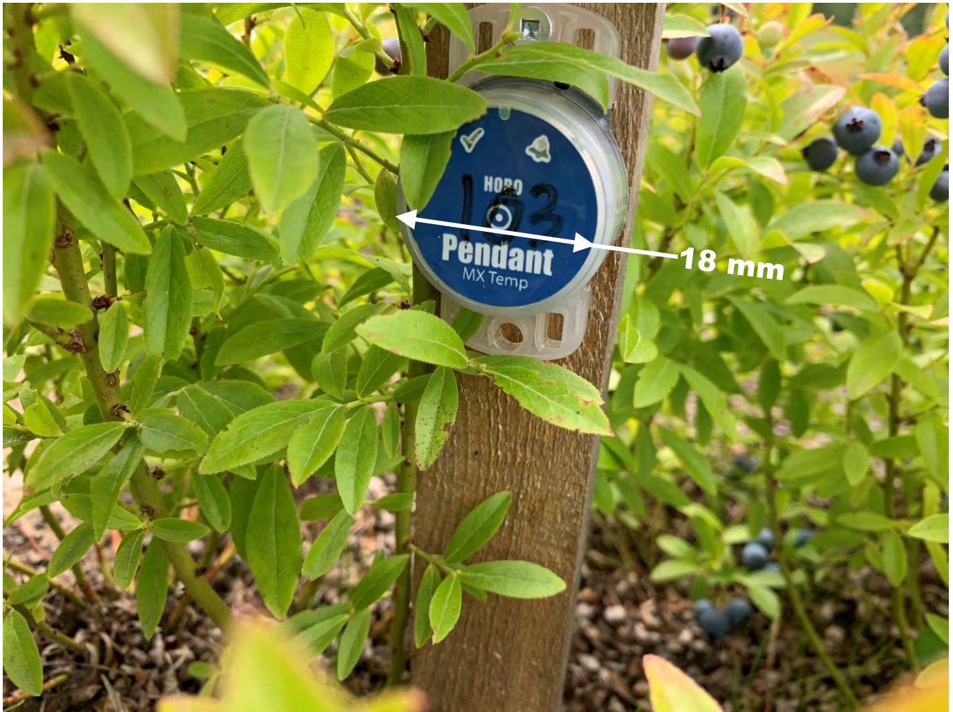
Figure 142. Capteur MX2201 (Onset) installé à la hauteur des fruits pour le suivi de la température de l'air, 22 juillet 2021.
