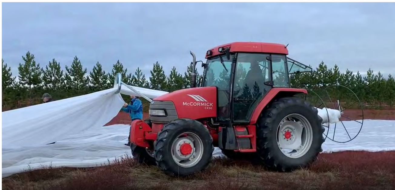
Figure 150. Enroulement avec système Hiwer d'une bâche pour le remisage à la suite d'une période de protection contre le gel, 25 octobre 2021.
