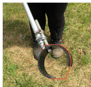
Les diffuseurs sont insérés sur la perche du côté opposé à la branche afin de retirer plus facilement la perche de l'arbre.
