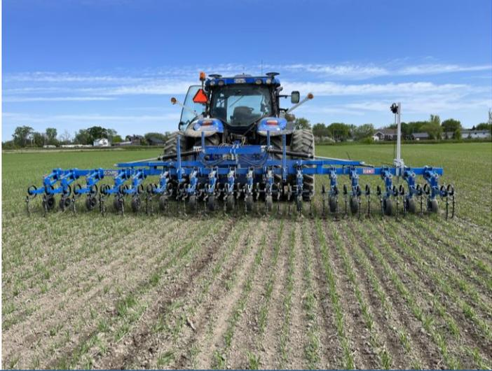
L'appareil utilisé est un sarcléur en rang, muni d'un système de guidage par caméra qui peut détecter huit rangées de larges pour garder sa position lorsque le sarcléur est en action. La vitesse d'avancement était de 8 km/h. Au-delà de cette vitesse, le blé avait tendance à être enterré, ce qui n'est pas souhaité. Le troisième point a été ajusté de manière à incliner l'appareil légèrement vers l'avant pour faciliter la pénétration des pointes des pattes.
