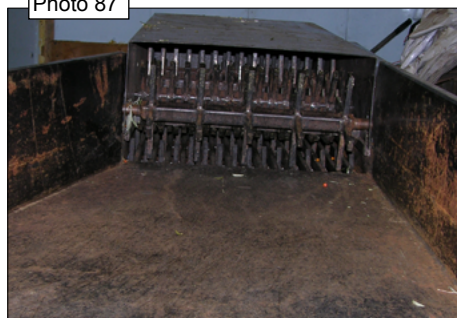
Rouleaux métalliques de la batteuse munis de « doigts »
