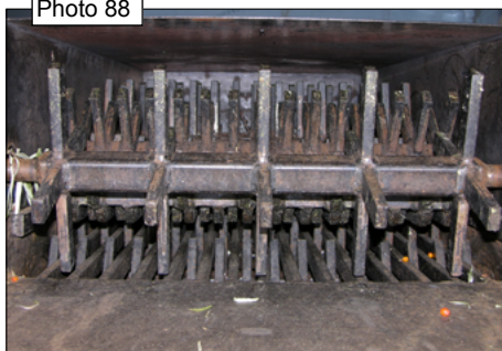
Rouleaux métalliques de la batteuse munis de « doigts » (détail)
