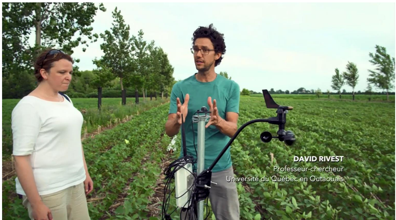
Figure 6. Centrale d'acquisition de données munie d'un capteur de rayonnement photosynthétiquement actif, d'un anémomètre, et de sondes d'humidité et de température du sol (photo Y. Rose).
