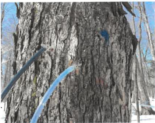
Fig. 1 – Dispositif d'entaillage apparié sur les mêmes arbres, utilisé pour comparer la tubulure bleue (claire) à la tubulure grise (foncée)
