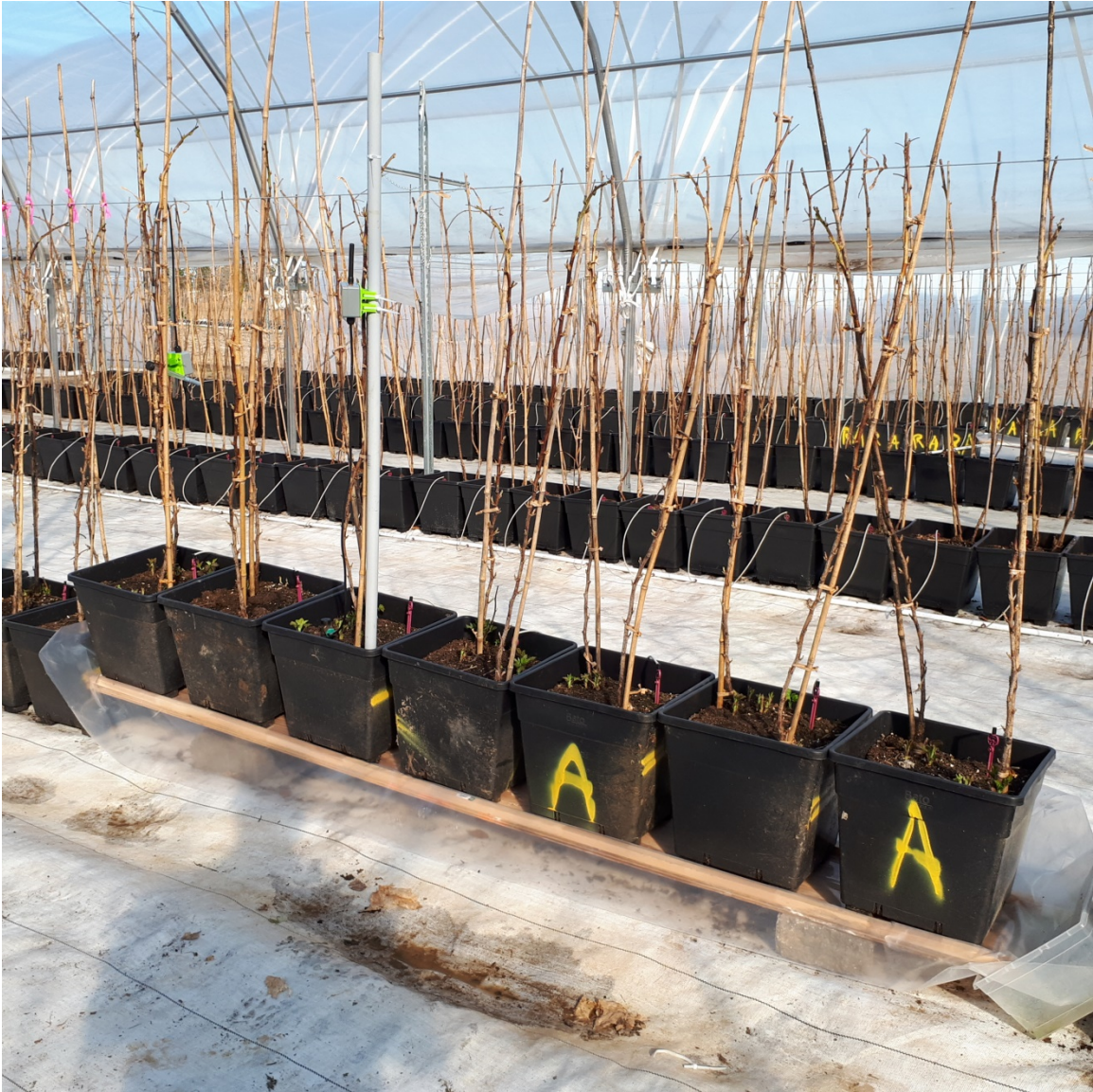
Photos 10 : Une dalle de lessivage avec 7 pots et un tensiomètre MLT sans fil
