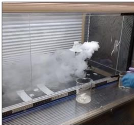
Figure 3 : Expérience d'observation de la diffusion de la plume dans le tunnel de vol (avec de la glace sèche)
