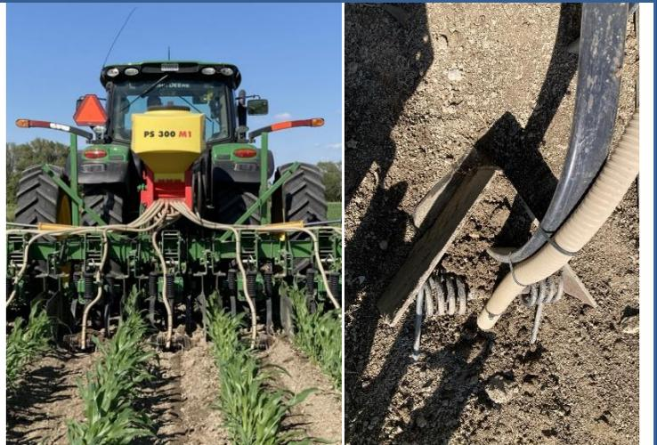
Il s'agit d'un sarcleur mi-lourd sur lequel un semoir à l'air est fixé. Les tuyaux de distribution des semences sont disposés sur les unités. Il y a eu un ajout d'une plaque de métal en « V » au-dessus de la pointe de la patte arrière (en « C ») du sarcleur. Les ressorts servent à faire vibrer le sol pour enterrer les semences d'engrais verts.
