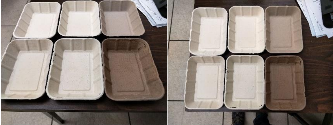
Figure 13 : Barquettes produites avec les différentes matières premières (de droite à gauche et de haut en bas : PE-SW; MG-SW; SCR-SW; PE; MG; SRC)
