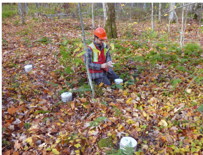
Figure 1 : Parcelle d'inventaire avec quatre chambres installées pour la mesure des flux de gaz à effet de serre
