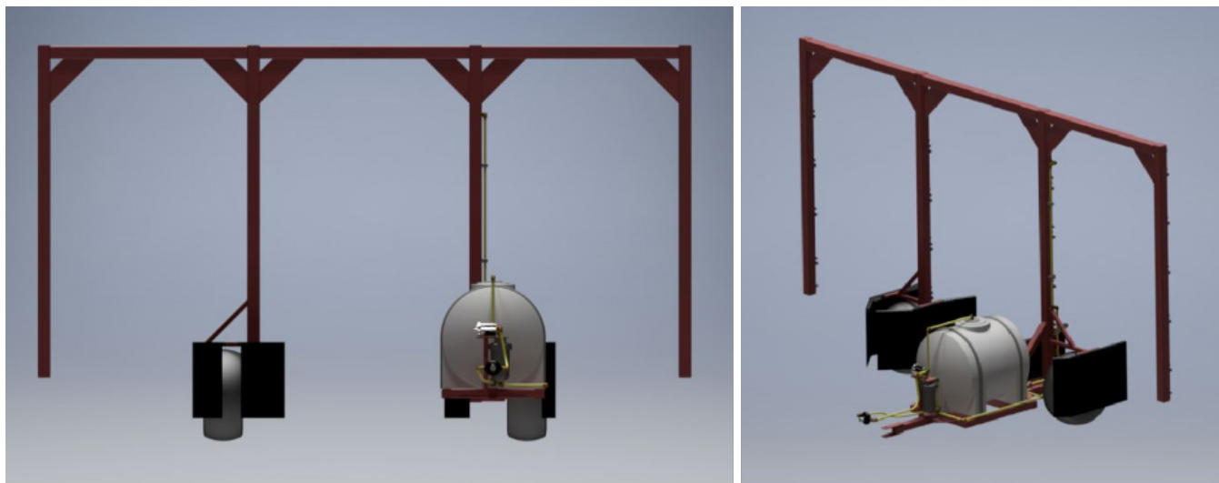
Figure 7. Rampe verticale à plusieurs arches (3 rangées)
