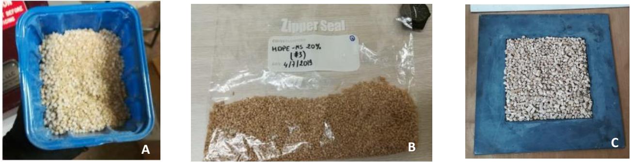
Figure 34. Granulations des fibres avec HDPE (A, B) et le moulage des plaques (C). (©PHOTO : Mathieu Robert, Université de Sherbrooke)
