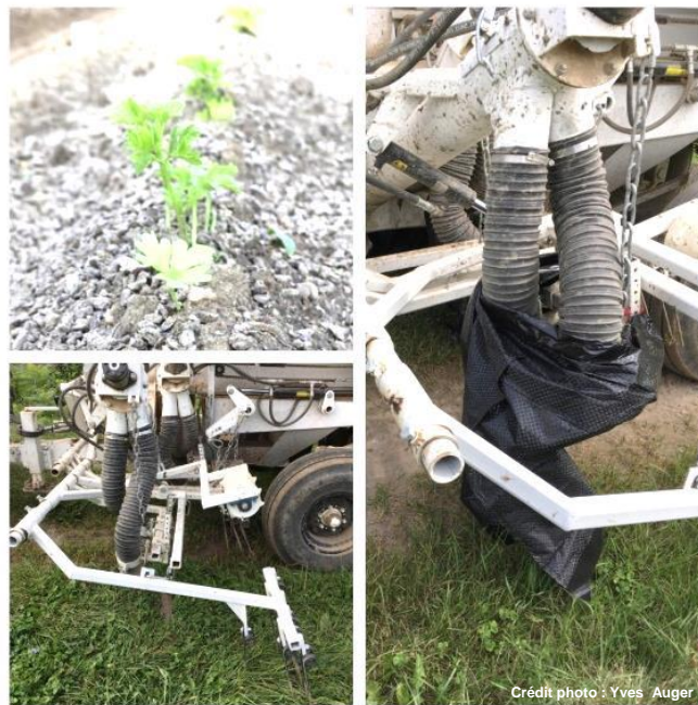
Figure 5. Montage permettant de récupérer les engrais lors de l'évaluation de la calibration de l'appareil
