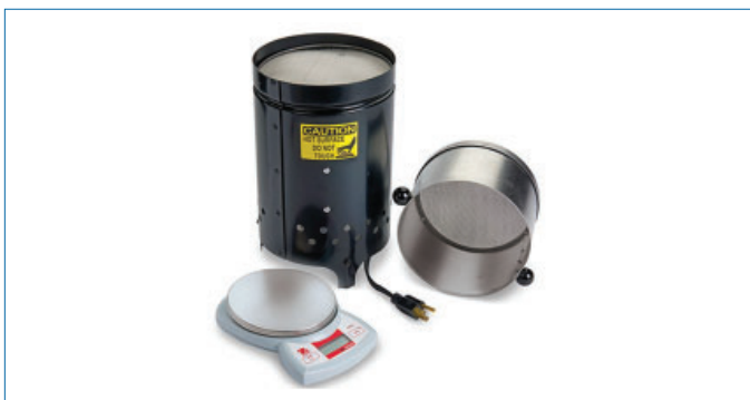
FIGURE 8. Mesure du contenu en matière sèche (appareil Koster®)
