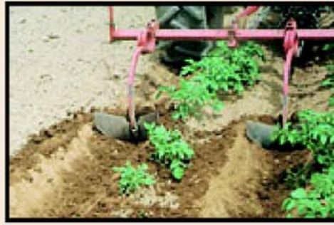
Dent en forme de versoir qui dépose le sol près des plants. Sert à la fois au sarclage et au buttage.
