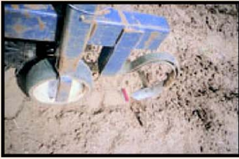
Dent étroite en S qui fait éclater le sol et le projette sur le rang. Très efficace à haute vitesse (12 km/h).
