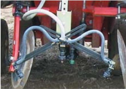
Vue d'ensemble du système d'application d'herbicide en bandes à trois buses installé sur les unités de plantation.
