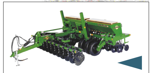
Semoir à céréales muni de coutres
