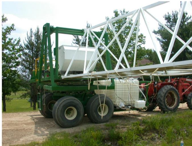
**Figure 21. Systèmes d'injection en rampe, pour application en grande surface dans les atocatières**
