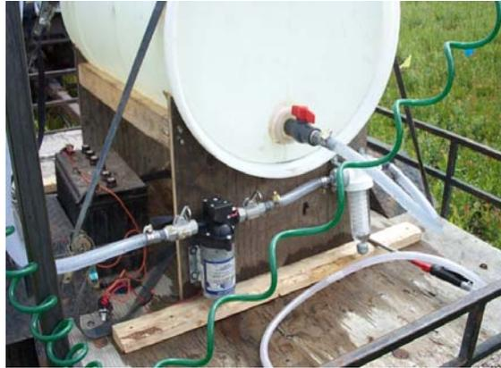
**Figure 3. Système d'application par injection pour un grand volume de produit**
