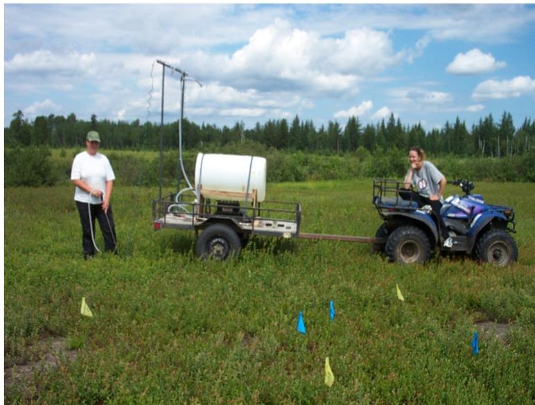
**Figure 20. Système d'application par injection pour petite surface**
