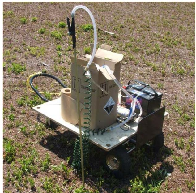
**Figure 4.** Système d'application par injection modifié pour appliquer un petit volume de produit
