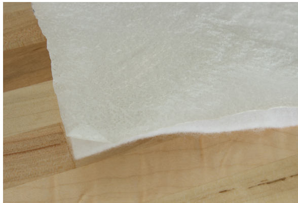
Illustration 3: Hibertex Pro laminé d'un polyéthylène microperforé.
