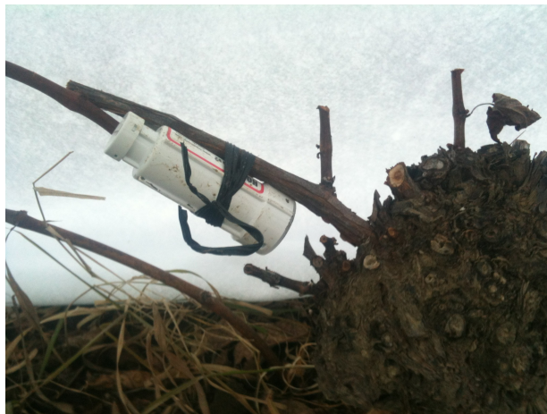
Illustration 2: Disposition des enregistreurs de température fixés à un sarment à environ 25 cm du sol, sous les protections.
