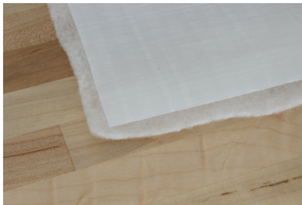
Illustration 4: Hibertex Pro recouvert d'un AirGuard.
