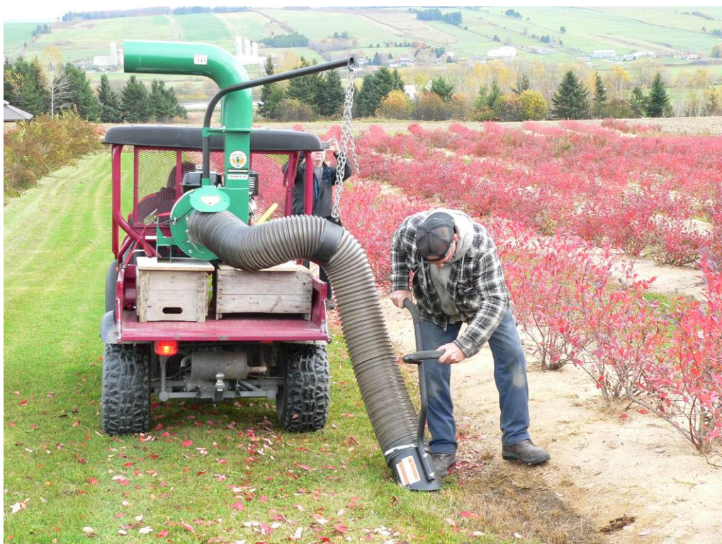
Photo 3 : « chargeur de débris/aspirateur » utilisé, de marque Billy Goat, modèle DL1301H, aspiration de 2 100 pieds cube par minute.
