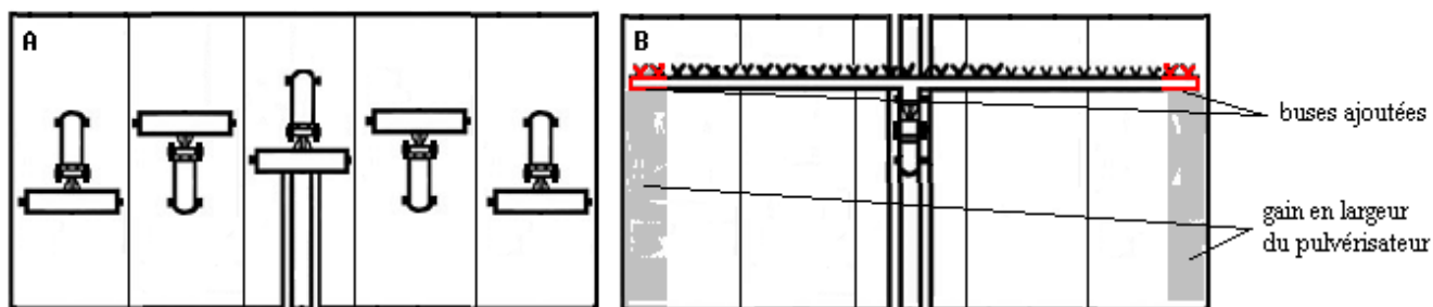
Figure 2. Illustration d'un ratio semoir/pulvérisateur de 1 : 5 obtenu par l'extension de la rampe de pulvérisation et l'ajout de buses. Le rapport initial entre les deux équipements était de 1 : 4.
