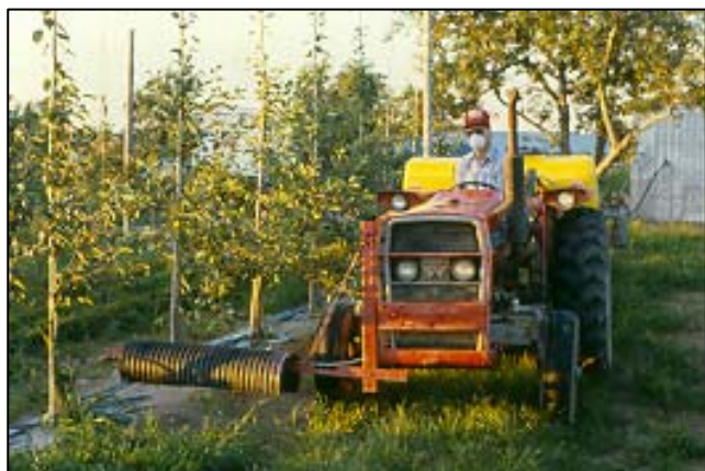
Figure 4: rampe à herbicides fixée sur le devant du tracteur
