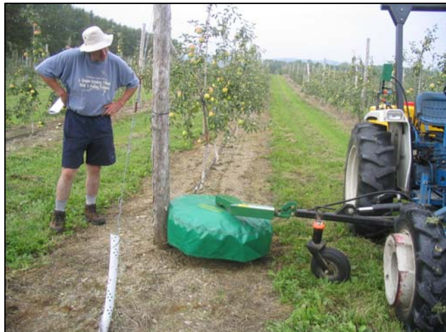
Figure 5 : l'applicateur d'herbicides Enviromist fixé sur le côté d'un tracteur.
