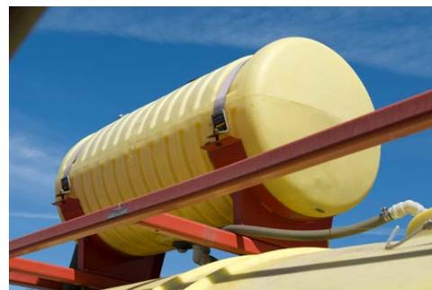
Pour effectuer le rinçage au champ, il est nécessaire de posséder un réservoir de rinçage contenant de l'eau claire. Généralement, il est conseillé que ce réservoir représente environ 10 % du volume du réservoir principal. Par exemple, pour un pulvérisateur de 4 000 litres, le réservoir de rinçage devrait être de 400 litres environ.
