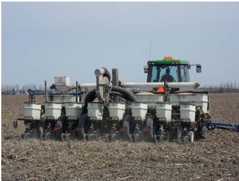
Figure 1. Semoir modifié pour expulser les poussières vers le sol (photo : P.-A. Thériault)
